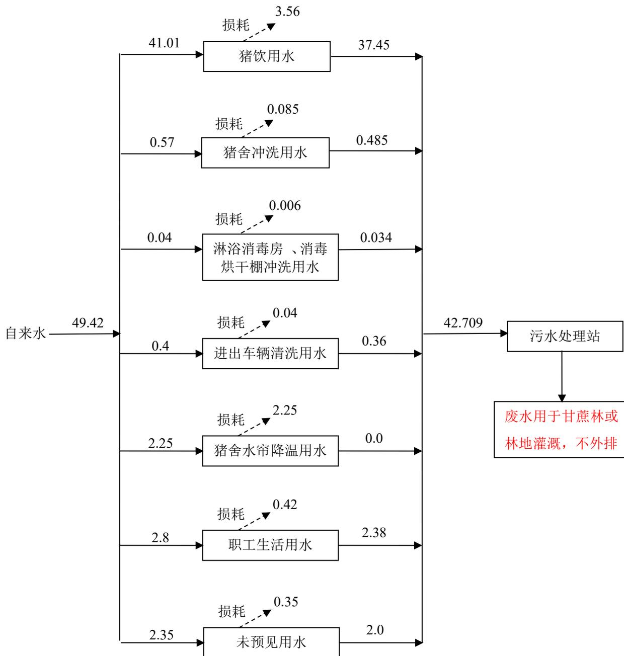
图 2.2-6 项目水平衡图
