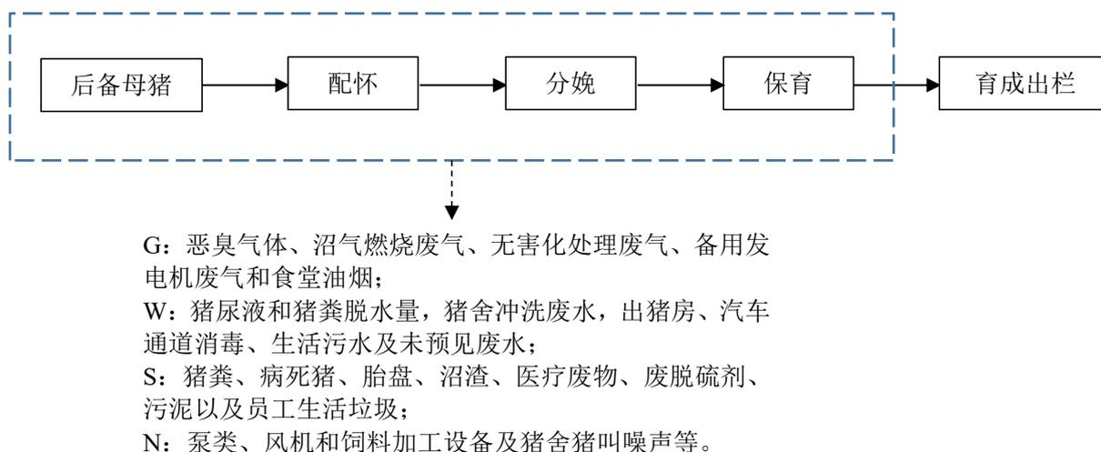
图 2.2-1 生产工艺产排污流程图
